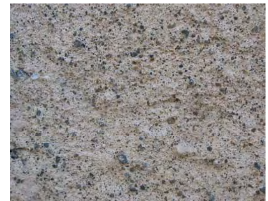
Arrebossats olotins amb diferent percentatge d'àrid.
