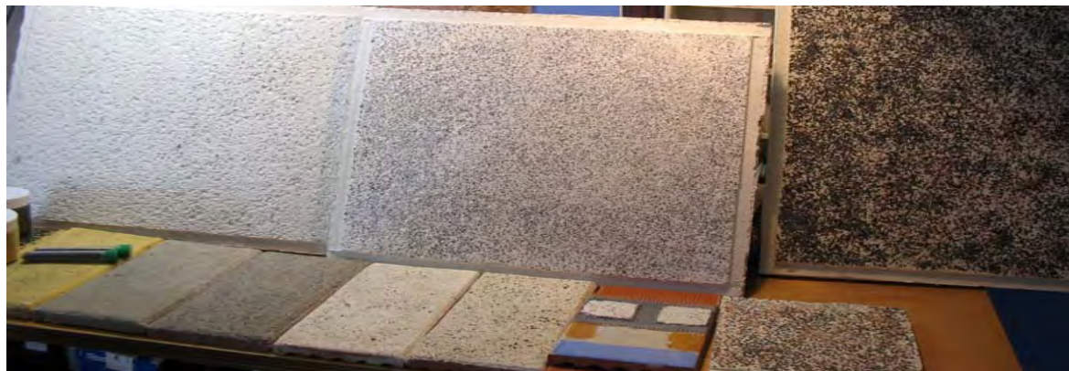
Execució d'un arrebossat olotí, amb mostres artesanes i industrials amb igual formulació i acabats.
