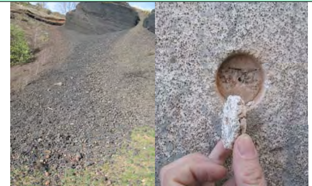
Gredera natural i arrebossat amb greda.
